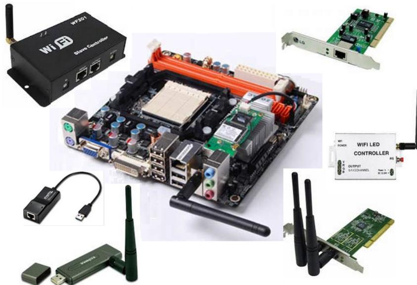
Figura 4.24: Controladores/adaptadores de red Ethernet y Wifi
