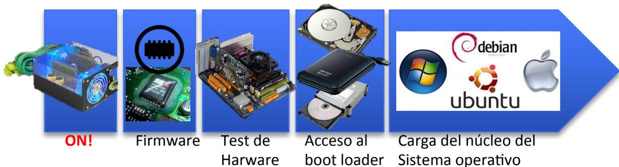
Figura 5.2: Proceso de arranque de un computador.
